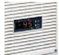
Fig. 3: Il termostato elettronico è facile da leggere e permette di tener monitorato lo stato del freezer
